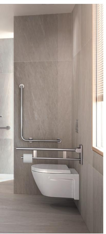
Dauerhafte, verlässliche Qualität zeigt sich nicht nur in den Materialien, sondern auch in den technischen Details. Die Stützklappgriffe von System 900 verfügen über eine wartungsfreie Bremse, die das Absenken des Griffs dämpft. Ein definierter Anschlag verhindert, dass der Stützklappgriff an die Wand schlägt.
